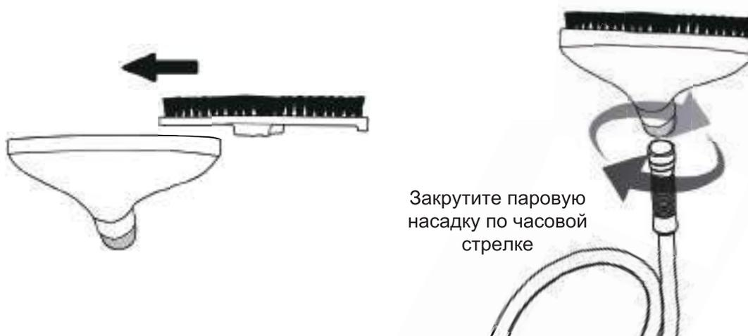
1: Наденьте паровую щетку на паровую насадку как показано на рисунке, и затем закрутите паровую насадку по часовой стрелке.
