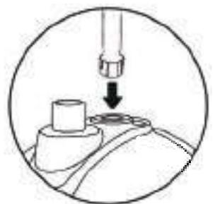
2. Вставьте штангу-держатель в корпус отпаривателя, как показано на рисунке, и закрутите по часовой стрелке
