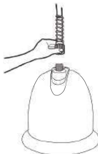
Закрутите паровой шланг в корпус отпаривателя по часовой стрелке.
